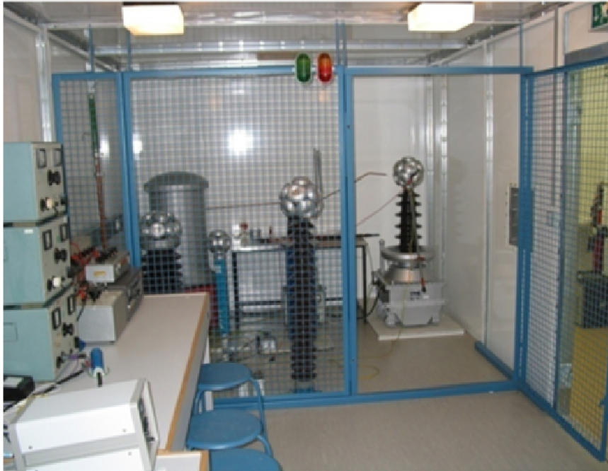
Abbildung: Geschirmte Messkabine zur Teilentladungs- und Verlustfaktormessung
