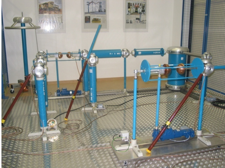
Abbildung: Prüfsystem zur Erzeugung von Gleich-, Wechsel-, und Stoßspannungen bis 100kV
